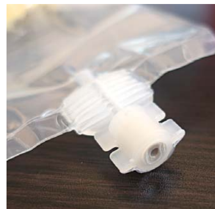
Babyplast производит детали клапанов для упаковок с питанием для космонавтов МКС
