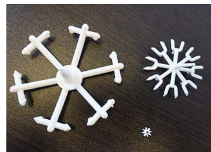
Литник, образующийся при литье мини-шестеренки (в середине) на стандартном ТПА (слева) и на мини-ТПА Babyplast (справа)
